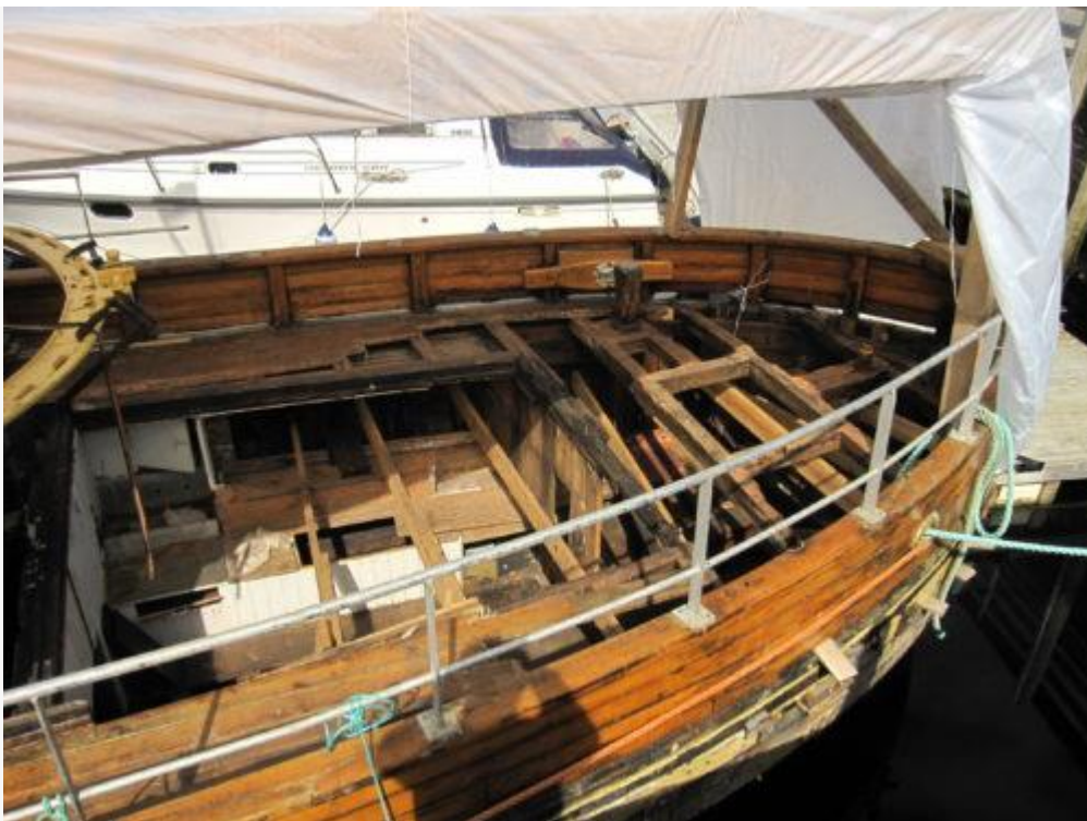
MB Hauka under restaurering i Kjerkesvågen. Akterdekket er tatt av og ødelagte dekkbjelker skal skiftes ut som en del av restaureringen.
